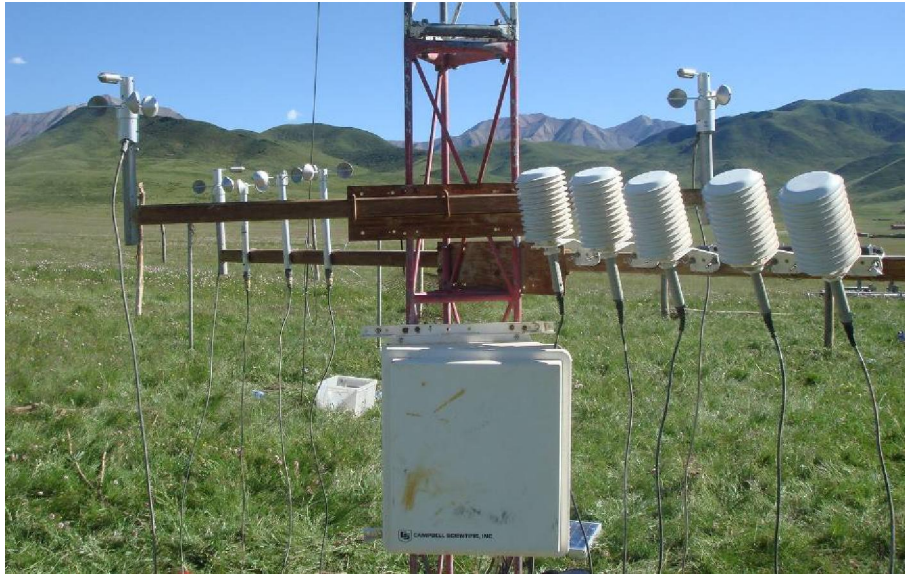
图 e-3 温湿和风速传感器的对比观测试验
