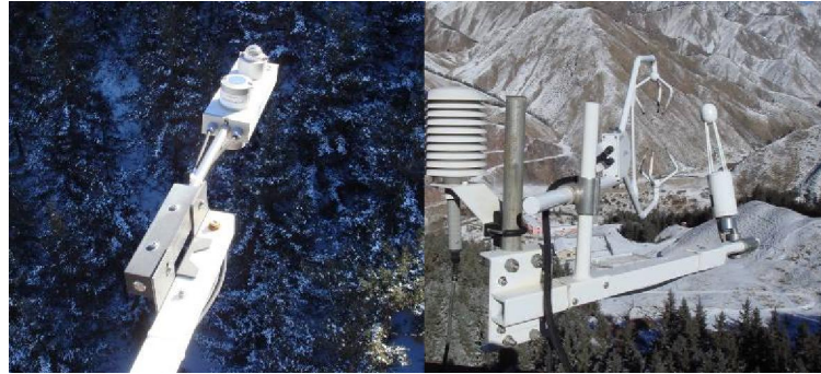
图 c-3 辐射四分量计、超声风速仪和气体分析仪
