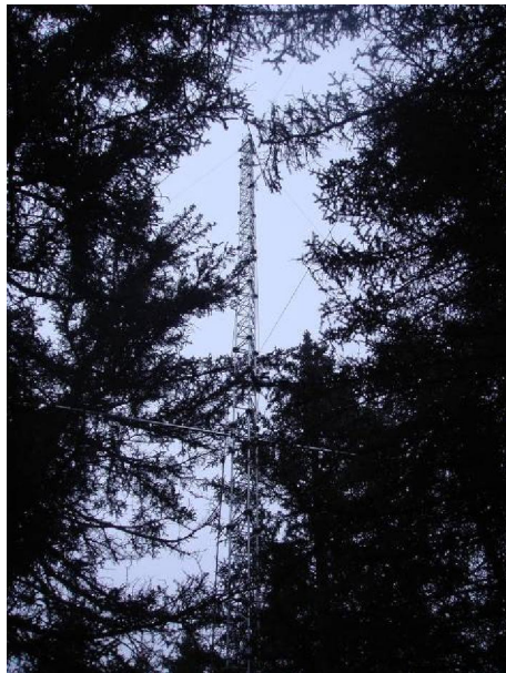
图 c-2 高 24m 的微气象观测塔
