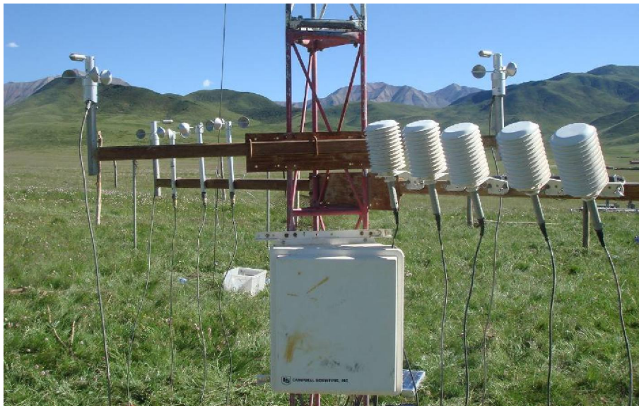
图 a-5 温湿和风速传感器的对比观测试验
