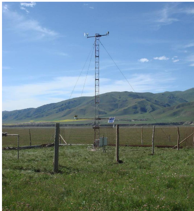
图 a-2 高 10m 的微气象观测塔
