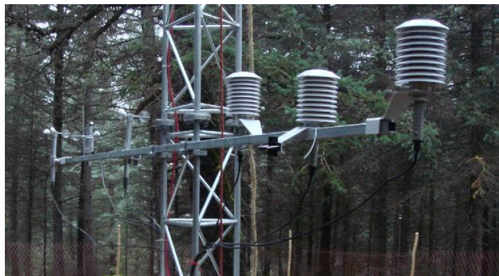
图 c-5 温湿和风速传感器的对比观测试验
