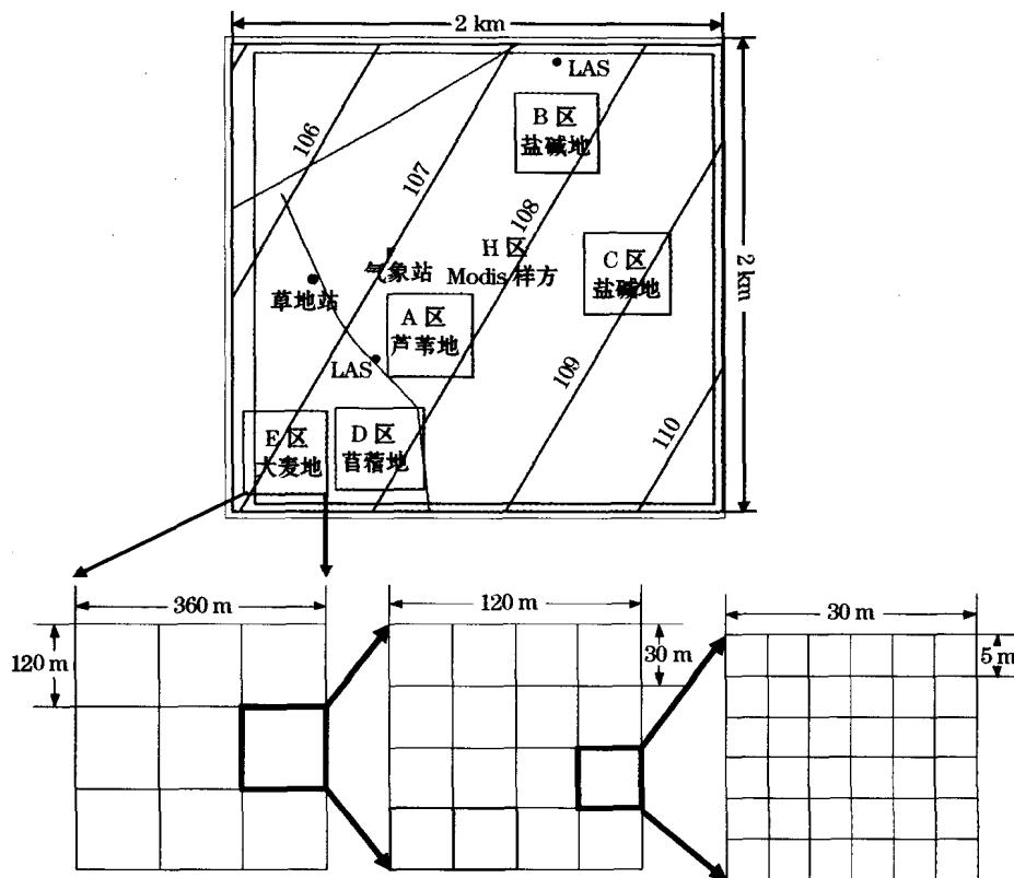
图5 采样方案示意图
